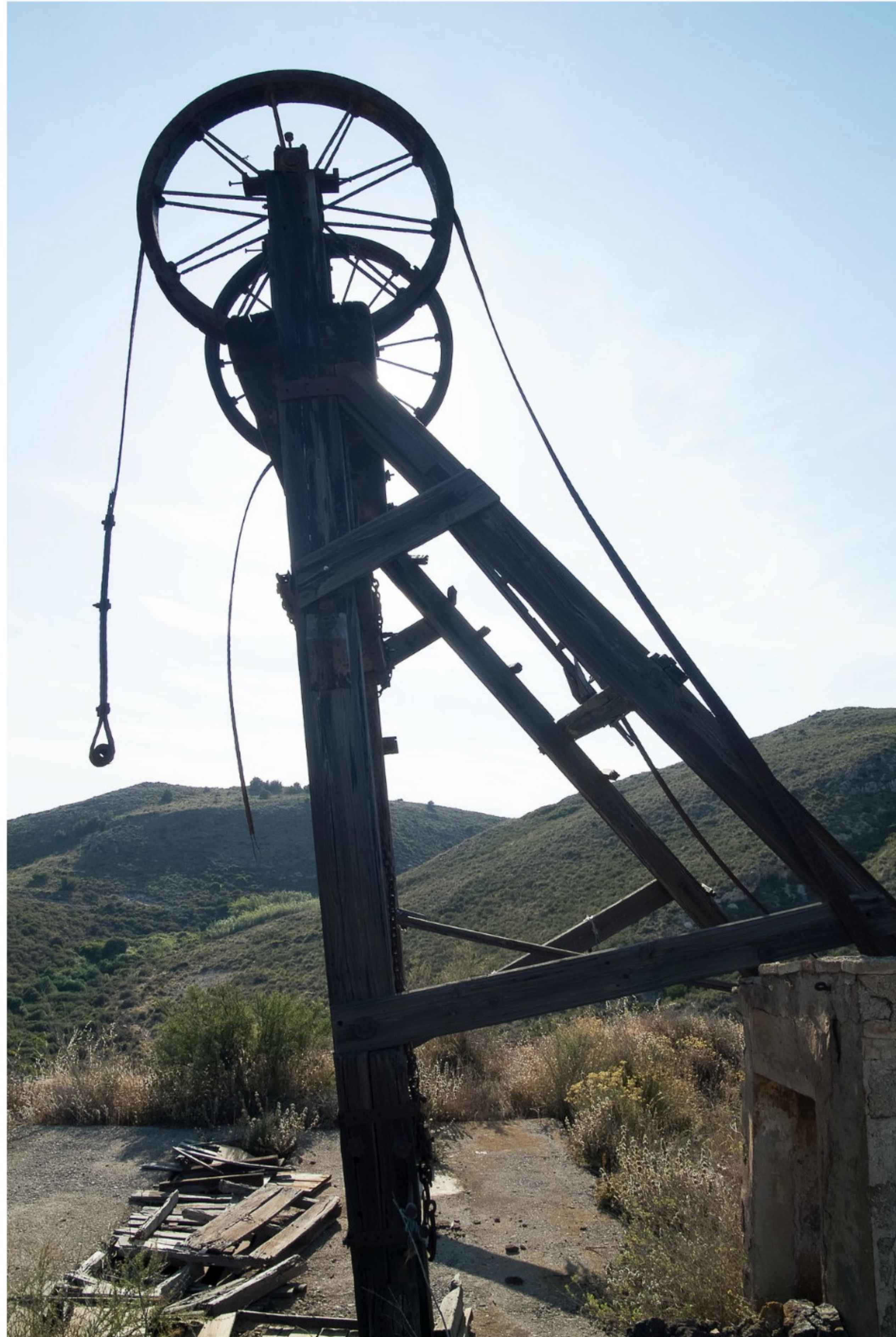
El castillete de madera, estructura situada sobre un pozo vertical de extracción, cuyo función es soportar las poleas a suficiente altura sobre el brocal (boca) del pozo para permitir las maniobras de extracción.
